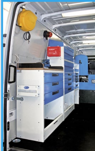
Iveco Daily con estanterías y cajones, con generador de 15 KVA y compresor 100 litros.
