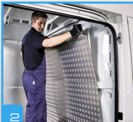
2 Partitions Separador de carga
