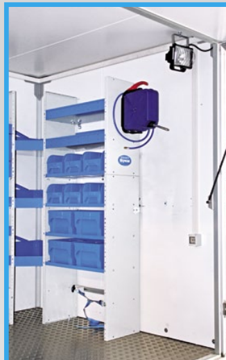
Taller móvil en el interior de un remolque de aluminio y fibra de vidrio.
