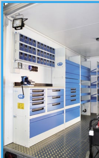
Taller móvil en el interior de un remolque de aluminio y fibra de vidrio.
