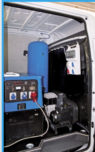
Iveco Daily con estanterías y cajones, con generador de 15 KVA y compresor 100 litros.
